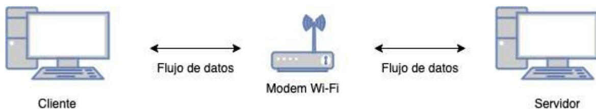
Figura 4.1.2: Descripción gráfica de las conexiones en el experimento Wi-Fi.
