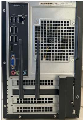
Figura 4.1.1: Tarjeta Wi-Fi/Bluetooth instalada en CPU.
