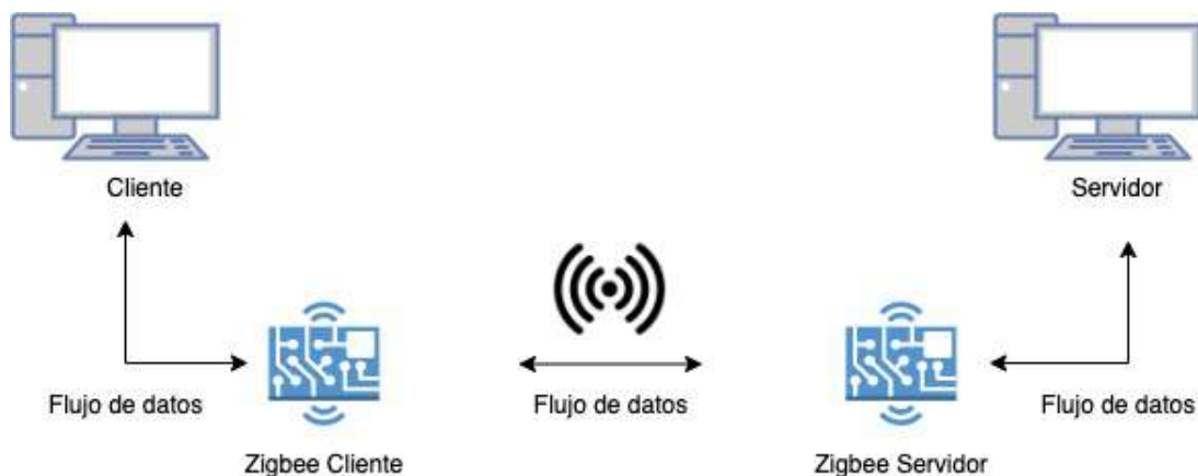
Figura 4.1.7: Descripción gráfica de las conexiones en el experimento ZigBee.
