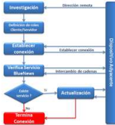
Figura 4 Diagrama de flujo del modo Cliente/Servidor.
